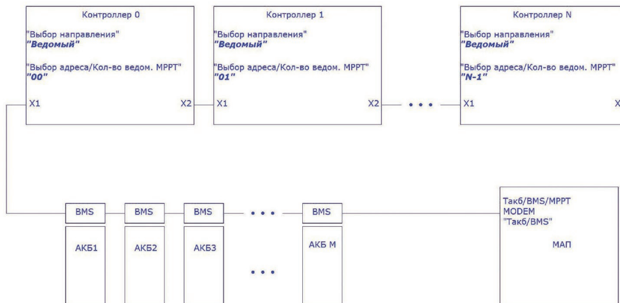
Рис. 1. Схема системы «Несколько Контроллеров +МАП+BMS».
